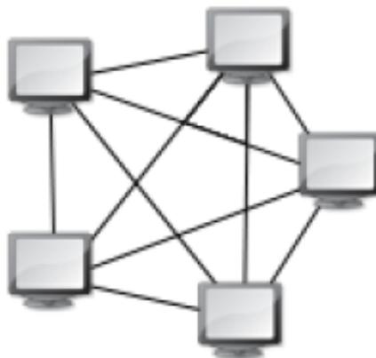
Tous les noeuds sont reliés 2 à 2 et communiquent directement. Ce type de câblage n'est plus utilisé car il nécessite beaucoup de câble. Avec  $n$  machines il faut  $\frac{n(n-1)}{2}$  câbles.
