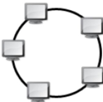
La communication repose également sur le principe du jeton qui circule dans la ligne et qui autorise ou non les communications. La rupture d'un des noeuds empêche le réseau de fonctionner. La mise en oeuvre est complexe.
